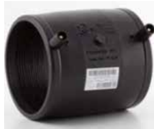
PE 100 RC Elektroschweiß-Muffe, SDR 7,4 PN 25, gespritzt
