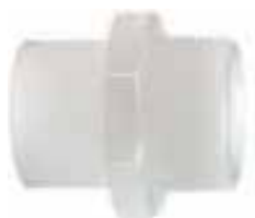
PVDF Übergangsnippel, SDR 21 PN 16, Aussengewinde Typ R, zum Stumpfschweissen
