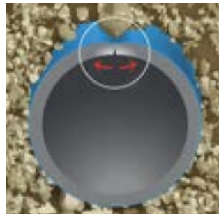
Der Riss beginnt an der Rohrinneenseite
