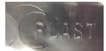
Standardaufdruck bei Formteilen „PLAST“
