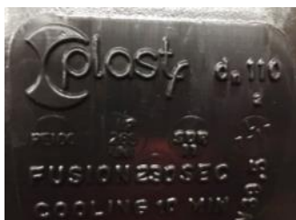
Anzeige einer PE100 SDR 11 E-Muffe mit „Plastf“ Aufdruck für Plastfast Daten sind direkt auf der Muffe aufgedruckt: Rohrdimension d 110 mm, Schweißzeit: 230 SEC, Abkühlzeit: 10 MIN
